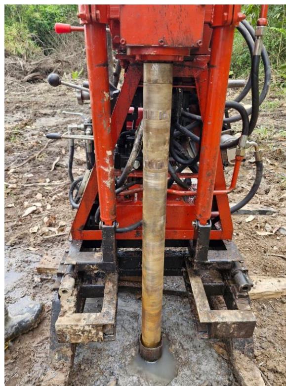
Figura 3 – Imagens demonstrando e execução do método de sondagem rotativo.
